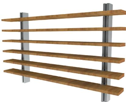
Celosía Gradpanel Serie CL W 80 de lamas fijas de madera maciza de cedro rojo, procedente de la costa oeste de Canadá, en posición horizontal o vertical para diferentes aplicaciones. Sección de lama 15 x 80 mm. Acabado Natural.
